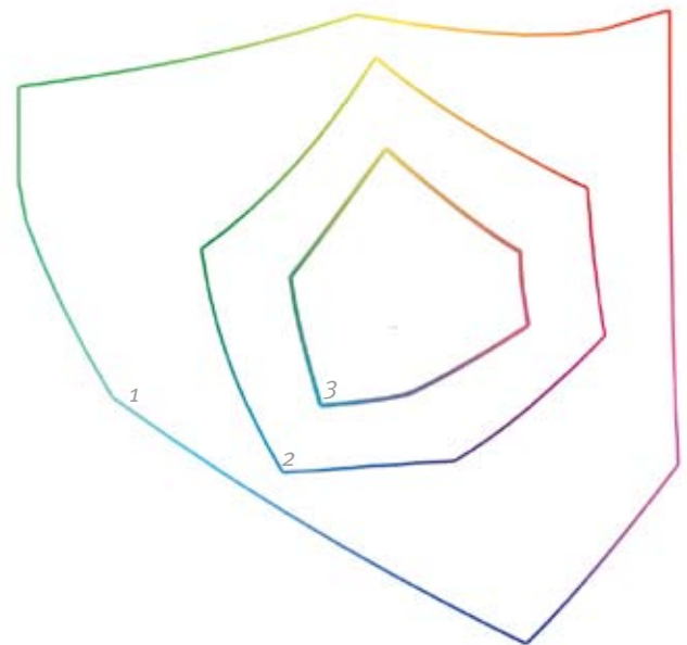
Der Vergleich zwischen ECI-RGB (1), ISOcoated (2) und ISOnewspaper (3) zeigt deutlich, dass der RGB-Farbraum die Druckfarbräume vollständig umschließt und sich damit optimal als Arbeitsfarbraum eignet.
